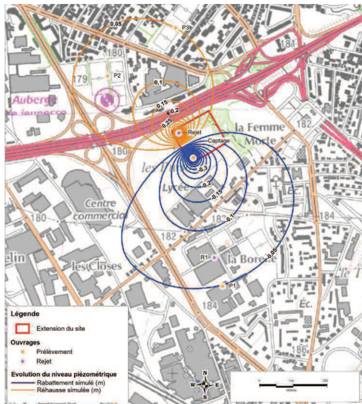
Figure 4 : Incidence de l'état final maximal : écart piézométrique entre l'état initial et l'état final avec exploitation de la nappe par l'installation géothermique d'IKEA à un débit de 210 m 3 /h
